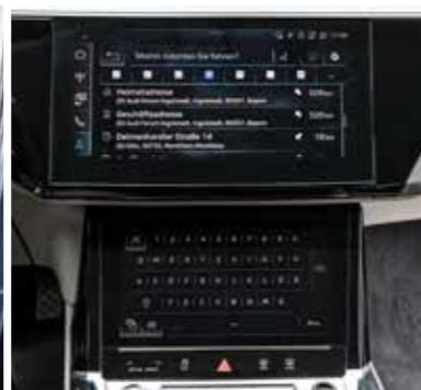
Der zweite Bildschirm fungiert bei Bedarf als einfach bedienbare Tastatur
